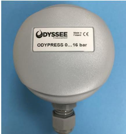
Le transmetteur de pression d'eau ODYPRESS est conçu pour détecter les pressions dans les systèmes d'automatisation HVAC. La pression est mesurée au moyen d'une sonde en céramique. Les milieux permis sont l'eau, les mélanges eau/glycol, l'air et les huiles.
